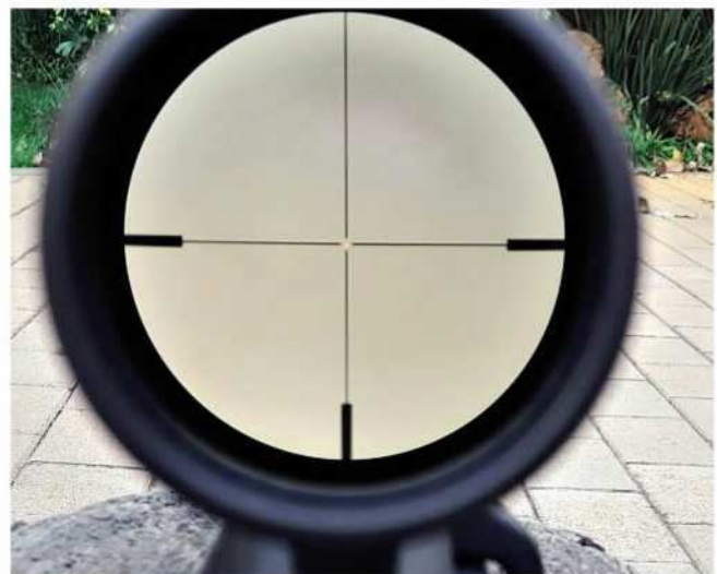
Die Blaser-teleskoop het 'n eenvoudige kruishaar met 'n senterkolletjie wat kan verlig en waarvan die intensiteit kan stel.
